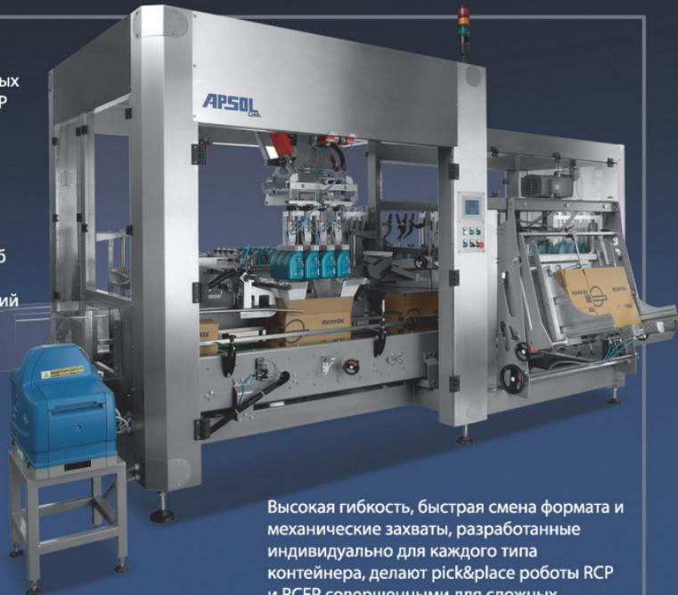
Высокая гибкость, быстрая смена формата и механические захваты, разработанные индивидуально для каждого типа контейнера, делают pick&place роботы RCP и RCFP совершенными для сложных условий работы в производстве бытовой
