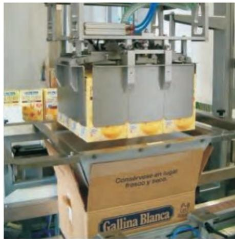
Различные системы головок захвата (механические, вакуумные, надувные...) делают укладчик высокоуниверсальной машиной для работы с широким спектром продукта. В зависимости от модели машины головки захвата оснащаются быстросъемным механизмом, что позволяет производить смену формата очень быстро.
