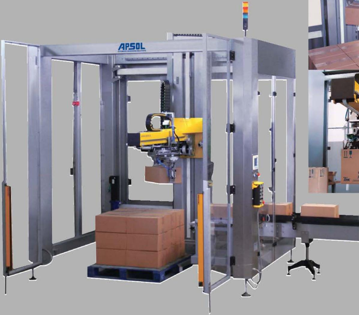
Координатный робот укладки на паллету **CP-G** представляет собой идеальное решение паллетизации линий средней производительности.
